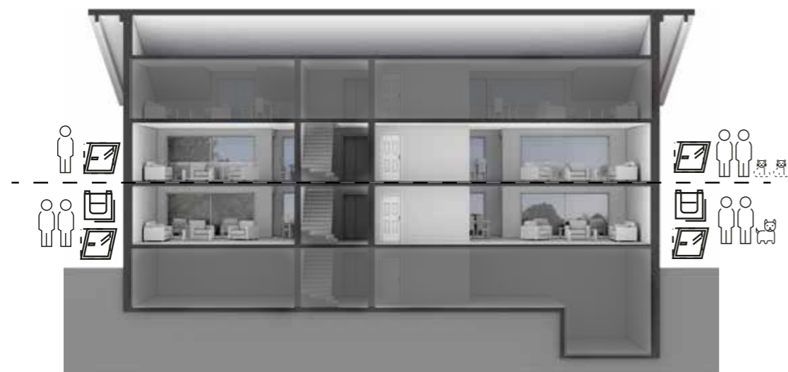
Abbildung 1: Gebäudeplanansicht mit Familiengröße und Lüftungsart.
